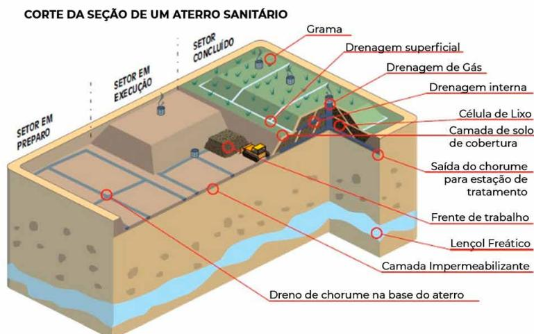
Figura 9 – Corte da seção de aterro sanitário.
